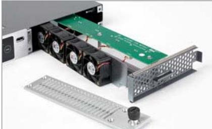
nShield Connect 6000 還有多個風扇，如有任一風扇故障，其他風扇仍可提供冷卻機體溫度的功能，風扇也可現場更換，這些設計就是為了增強設備的可用性。多台 HSM 可提供彼此備援及負載平衡 (clustered and load balanced)
